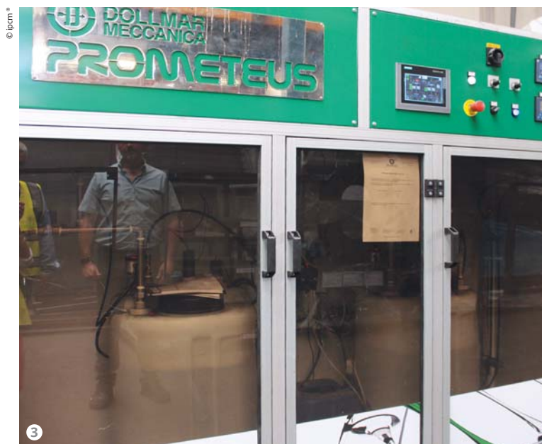
Figura 3: La macchina di pretrattamento Prometeus di DN Chemicals per l'applicazione di prodotti nanotecnologici.
