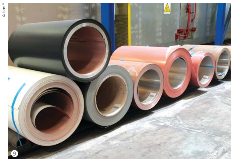
Figura 9: Coil verniciati con vari effetti: dalla finitura "rame" a quella simil-ossidata fino all'effetto opaco.
