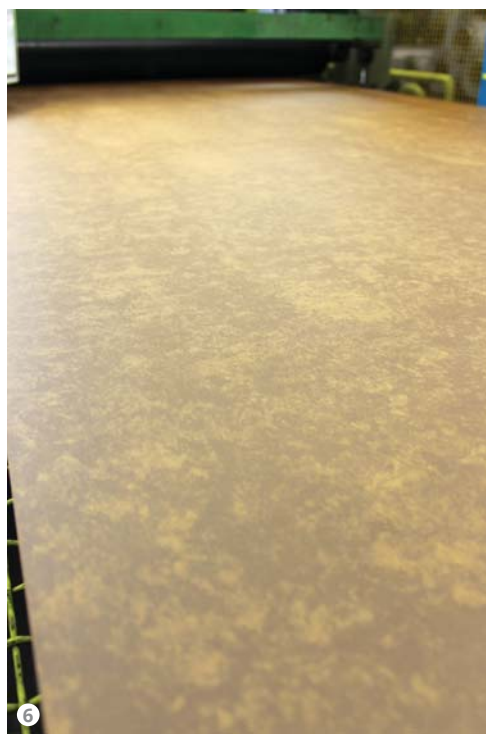
Figura 6: Il nastro verniciato all'uscita dal forno di cottura transita in una zona dedicata al controllo qualità.
