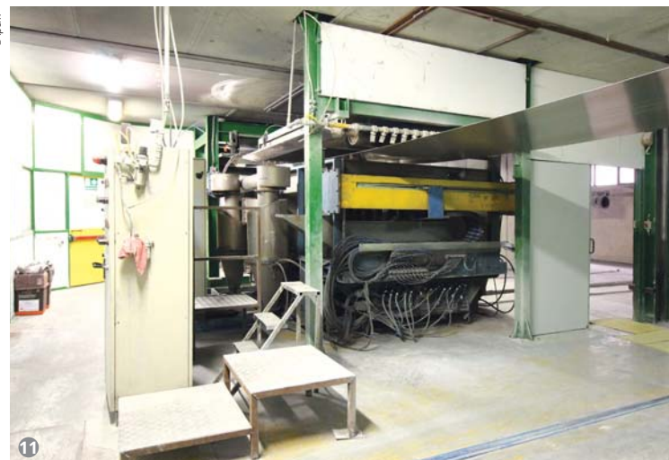
Figura 11: Una delle due cabine per l'applicazione delle vernici in polvere.
