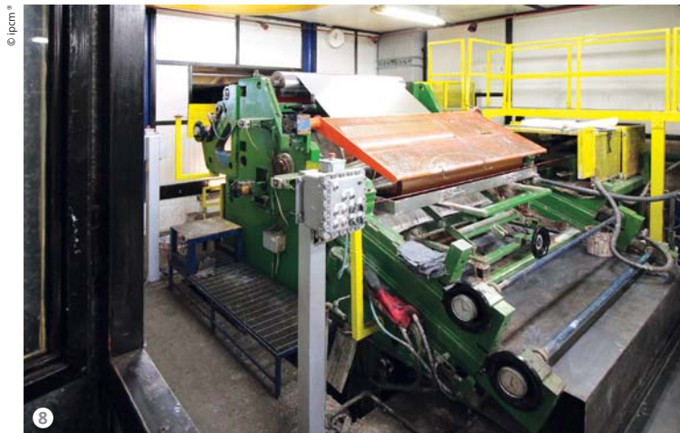
Figura 8: Una testa verniciante con prodotti liquidi.
