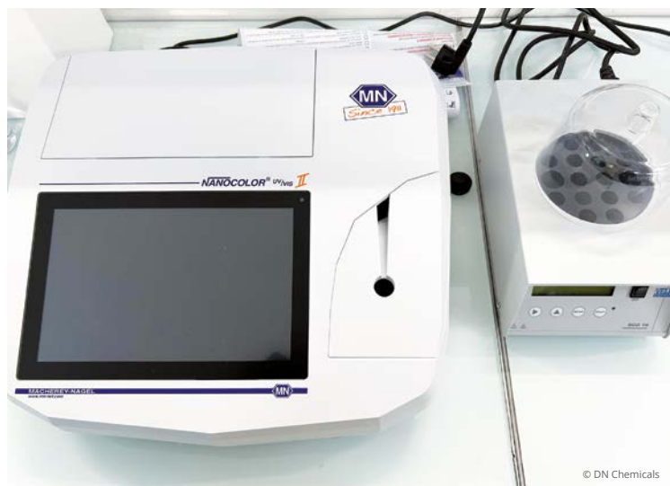
Lo spettrofotometro per la determinazione di inquinanti metallici nelle acque.
