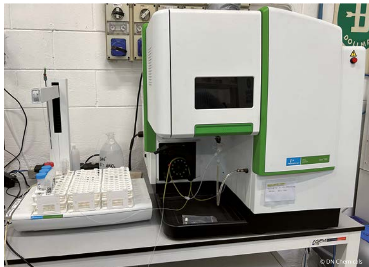
La strumentazione ICP per la spettrometria ad emissione al plasma.
