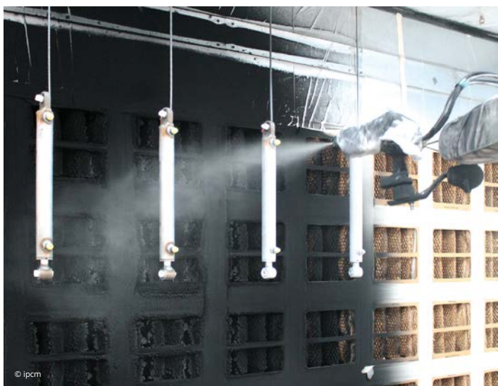
Applicazione della vernice con robot antropomorfo.
