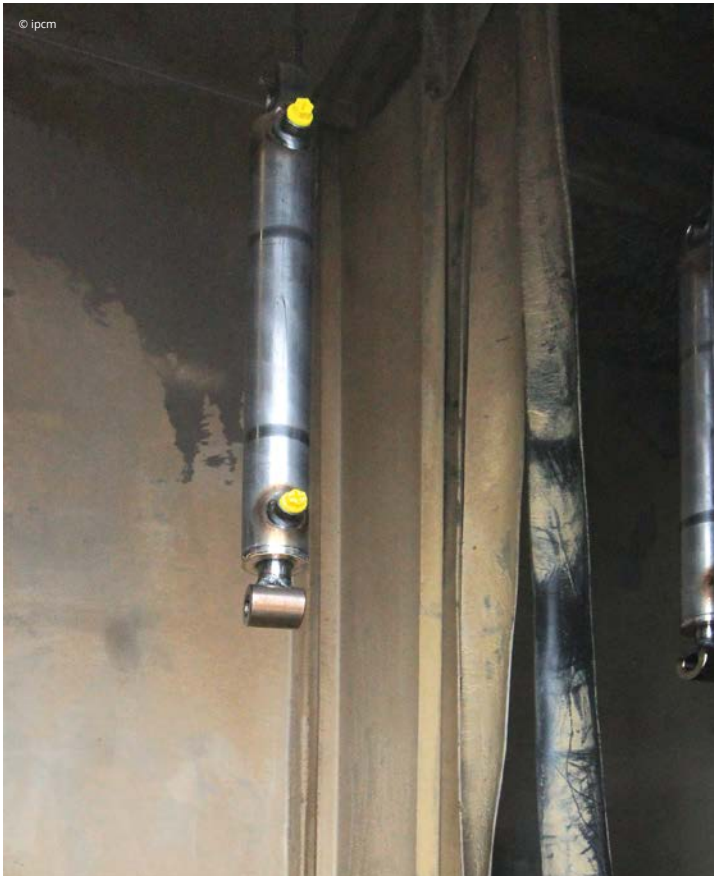
Un cilindro oleodinamico in uscita dal tunnel di pretrattamento.
