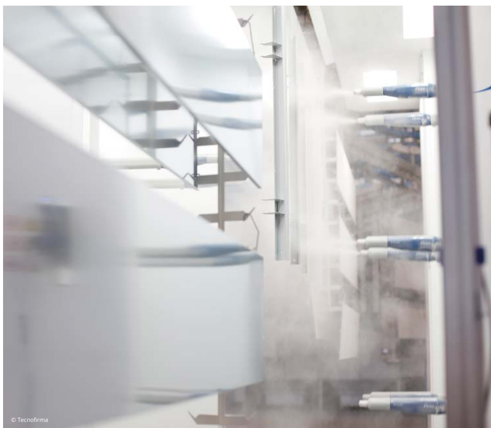
Una fase dell'applicazione di vernice.
