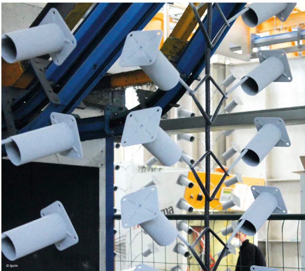
La postazione di pre-ritocco della cabina applicazione polveri di Gema Europe. Nitesco vernicia al suo interno tutti i componenti.
