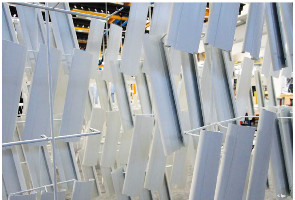
Il polmone di accumulo nella zona di scarico e alcuni particolari verniciati.
