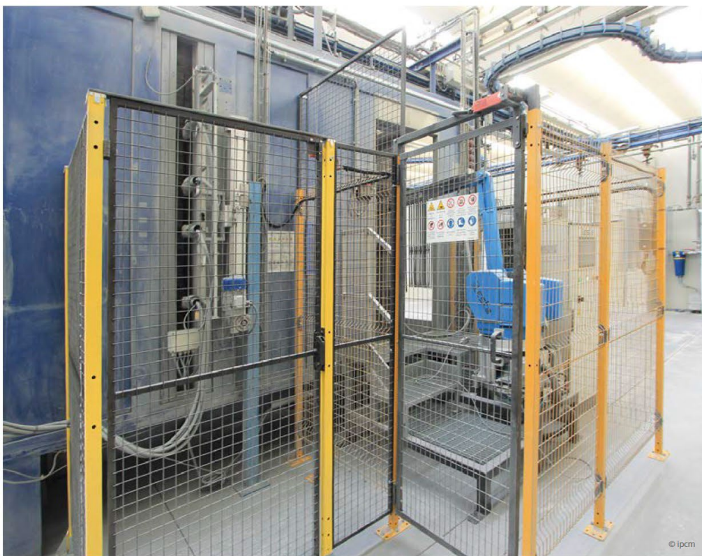
Una delle cabine di verniciatura con robot antropomorfo di Lesta.
